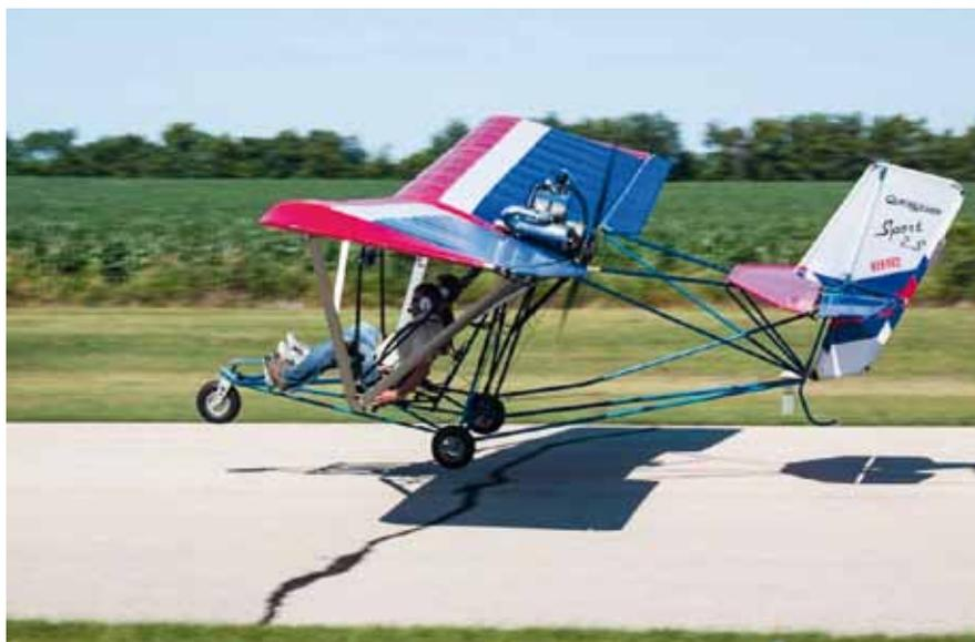
QuickSilver MX 40 CV. peso max al decollo 250 Kg. Ultraleggero americano tubi e tela acquistato da Guido Salvagnini in scatola di montaggio nel 1987.
