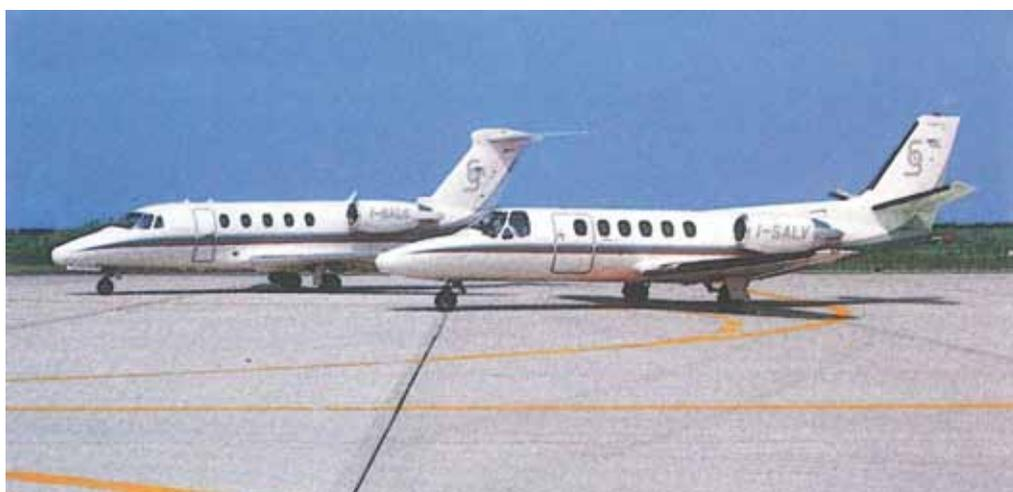
I-SALV Cessna Citation II business jet. Velocità di crociera 750 km/h, tangenza 13.000 m. Autonomia 3.700 km. 6 passeggeri e 2 piloti. I-SALG Cessna Citation III business jet. Velocità di crociera 875 km/h, tangenza 15.500 m. Autonomia 3.700 km. 8 passeggeri e 2 piloti.
