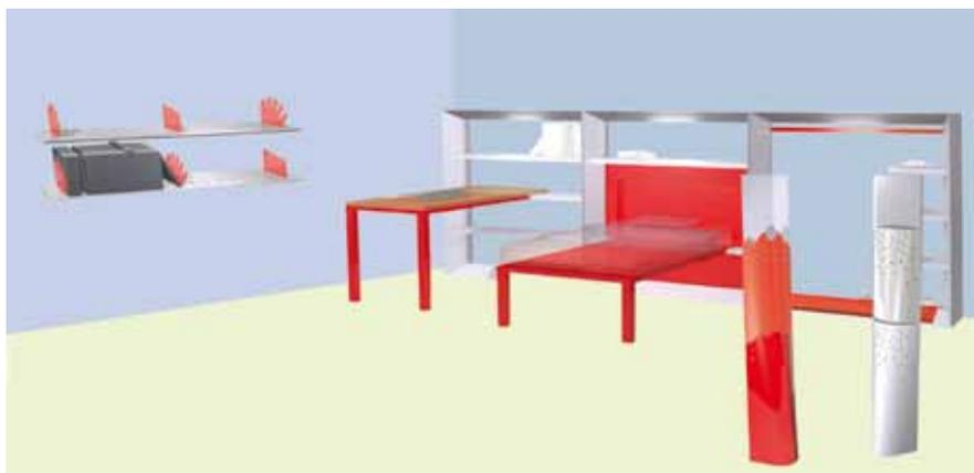
Roberto Pezzetta – Mensole, libreria e lampade da terra. Mensole a struttura portante e gusci di rivestimento eseguiti con tranciatura e piegatura; separatori ottenuti con taglio laser. La libreria, sempre da operazioni di tranciatura e piegatura e un oggetto modulare e configurabile.
