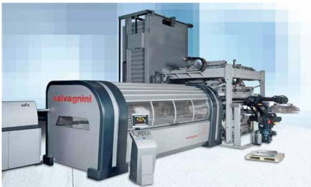
2001 - Sistema laser L2 ad alta dinamica completo di magazzino lamiera e sistema robotizzato di selezione e impilamento fogli tagliati.
