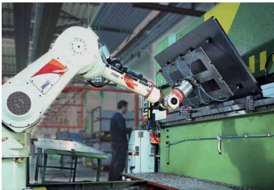
1996 - Prototipo cella robotizzata con pressopiega Warcom e robot Kawasaki.
