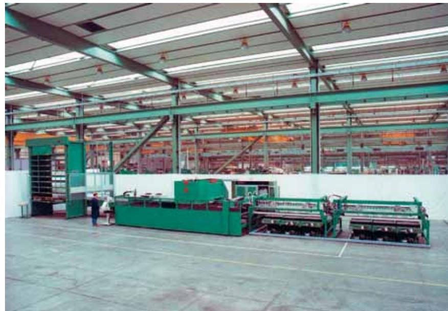
1993 - Sistema S4 PRO-Nest con magazzino fogli Tivox. L'alimentazione dei sistemi S4 e delle linee S4+P4 iniziava a mutare dai disimpilatori fogli verso i magazzini verticali per una effettiva miglior logistica di sistema. Da qui nasceranno poi le evoluzioni verso le logistiche di fabbrica con i magazzini Salvagnini a fogli singoli MD (1995) e a pacchi MV (1999).
