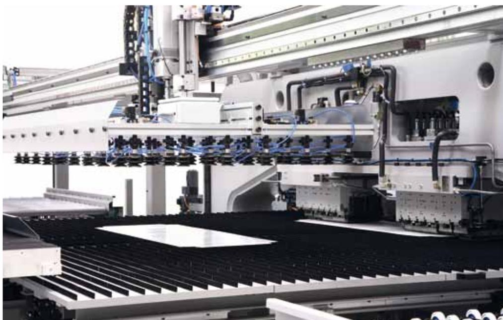
Piano di lavoro con le due teste multipressa S2 e trave di alimentazione-scarico.
