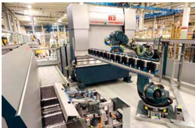
2013 - ROBOformER a valle di una linea S4+P4 per la produzione di profili nel settore della climatizzazione. La pannellatrice è modificata con un manipolatore speciale adatto ai profili.
