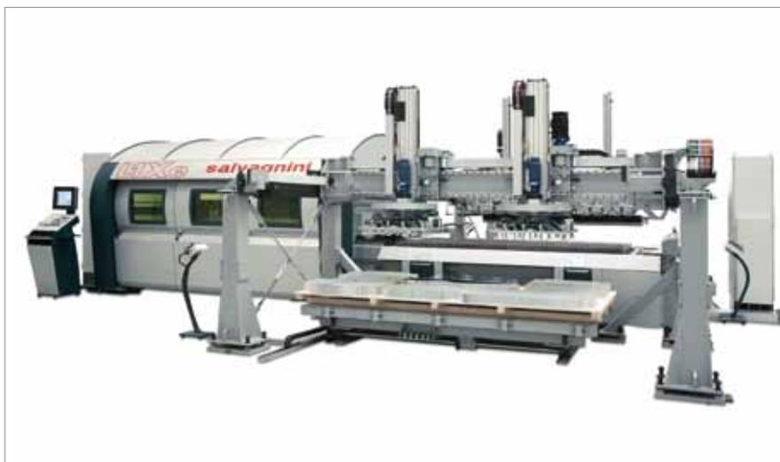
Prototipo sistema laser con sorgente in fibra esposto alla Euroblech 2008. In primo piano il sistema di selezione e scarico pezzi.
