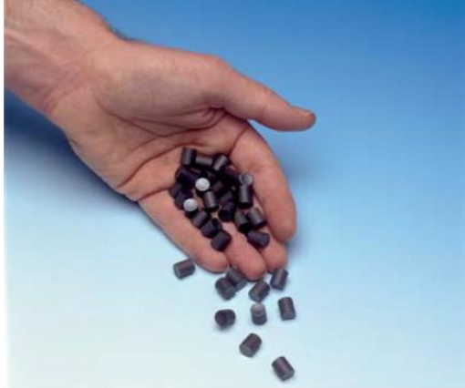
Combustibile d'uranium sous la forme qu'il présente pour son utilisation dans les centrales nucléaires. Deux de ces pastilles d'oxyde d'uranium (UO 2 ) permettent de couvrir la consommation d'électricité d'un ménage de quatre personnes pendant un an.
